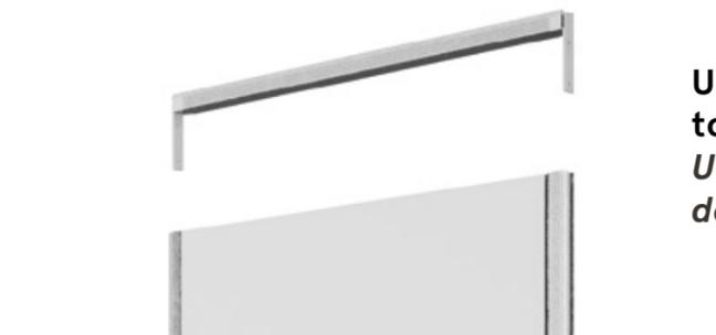
Use the upper crossbar to determine the opening direction. Utilisez la traverse supérieure pour déterminer la direction d'ouverture.
